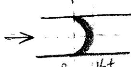
可溶物分布为一抛物面  $X = V_0 t (1 - \frac{r^2}{a^2})$ ，其径向厚度不变，为  $\delta X$ 。
