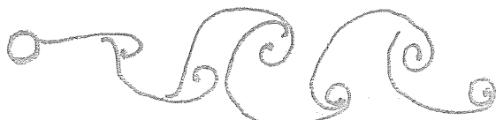
空气中释放的烟线绕圆柱流动。 (瞬时拍照)
