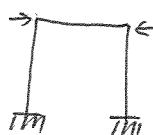
在图示对称载荷作用下，截面法假设<sup>\*</sup>，算得结构内力为零，只有轴力。
